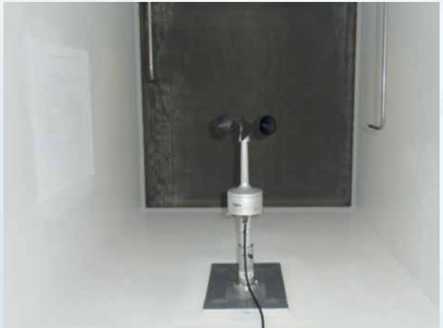
Sensor de velocidad en el túnel de viento del Instituto Universitario de Microgravedad "Ignacio Da Riva" de la Universidad Politécnica de Madrid
