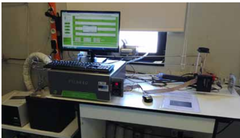
El nuevo analizador Picarro para la determinación simultánea de CO 2 , CH 4 , CO y H 2 O mediante la innovadora técnica “Cavity Ring-Down Spectroscopy”.
