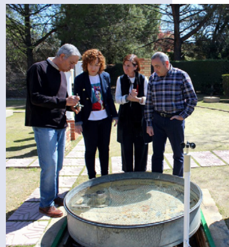
En el Tanque Evaporimétrico, Jose Calvo utilizando el tornillo limnimétrico para la medida de la evaporación en el pozo tranquilizante.
