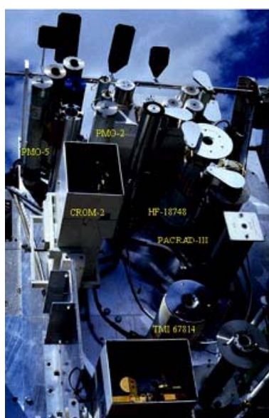
Batería de Pirheliómetros de Cavidad del WSG
