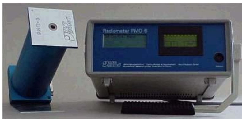
Pirheliómetro de cavidad propiedad del Centro Radiométrico Nacional
