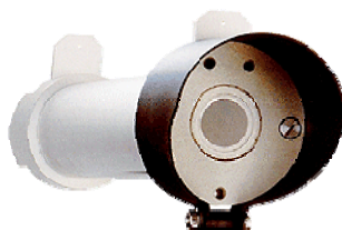
Pirheliómetro de primera clase Kipp-Zonen
